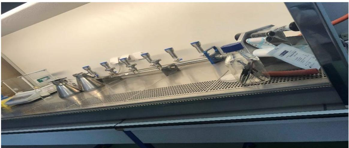
**Figure 26 :** Rampe de filtration
